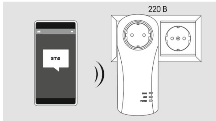
SMS-команды, которые принимает GSM розетка, приведены в таблице. Для управления GSM розеткой отправьте с основного телефона на номер розетки SMS-команду из таблицы.
