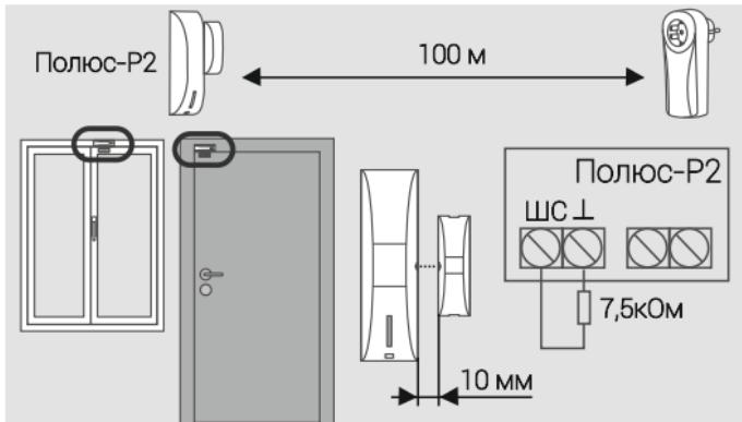
Подключение дополнительных проводных магнитоконтактных датчиков к «Полюс-Р2»
