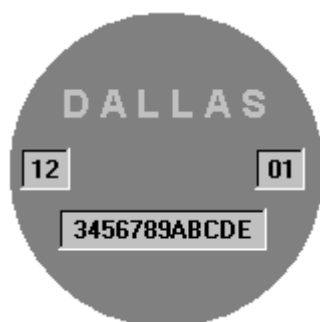
Рисунок 6.15 Расположение кода на ключе Touch Memory
